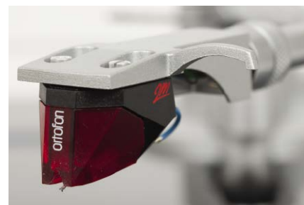
Fabrycznie zainstalowana wkładka Ortofon 2M Red to już niemal klasyk, na którym polegają producenci tańszych i droższych gramofonów. To wkładka MM, więc z nią nie uruchomimy transmisji zbalansowanej.
