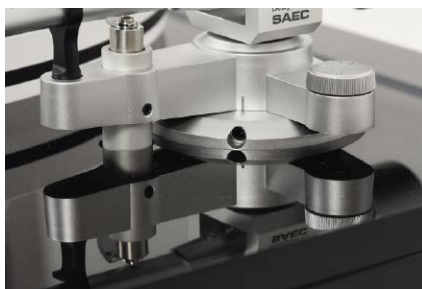
W tańszych gramofonach Teaca zakres regulacji ramienia bywa ograniczony, ale w tym przypadku mamy właściwie wszystko, włącznie z ustawianiem kąta VTA. Pominie to jedynie regulację azymutu.
